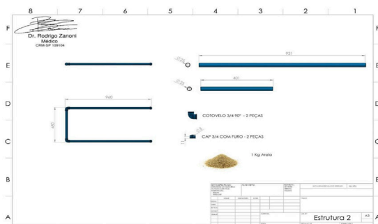
Figura 5. Desenho Montagem Estrutura do D.I.I.A
